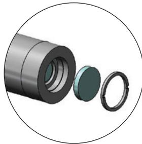
**+** Afin de garantir l'étanchéité de l'endoscope, la gaine de refroidissement peut être équipée d'un hublot en silice.
